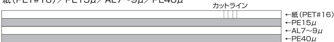
特殊コート(PVDCコート等)加工することにより、耐薬品性に優れ静電気の発生(帯電)を抑えることができます。更にシール部の粉塵等にも影響されず適切なシール強度を保てるとともに、大変簡単に内容物を取り出すことができます。
